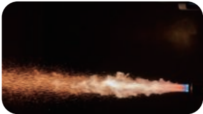
超音速火焰喷射涂层
